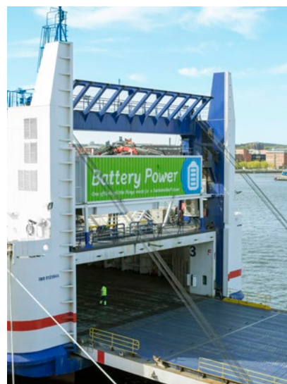
På Stena Jutlandica driver batterier de effektkrävande bogpropellarna vid manövrering i hamn.
